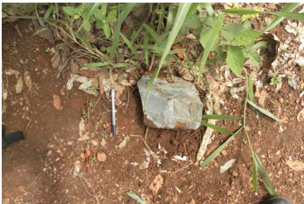
Figura 35 – Fragmento de rocha lançado a sul da mina pelo desmonte das frentes de lavra.
