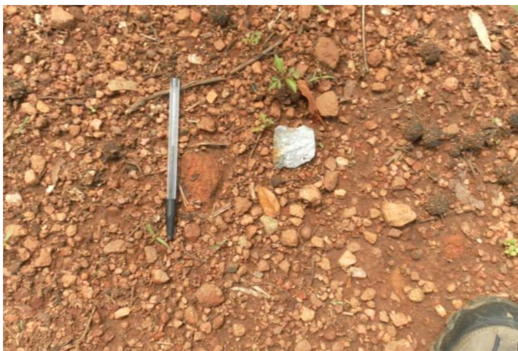
Figura 36 – Fragmento de rocha lançado a sul da mina pelo desmonte das frentes de lavra.
